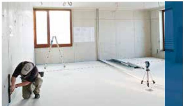
El Láser de Puntos y de Líneas Cruzadas GCL 25 reúne dos tipos de nivel a láser en un solo equipo: el láser combinado proyecta dos líneas cruzadas y cinco puntos. Usted puede elegir la función adecuada dependiendo de la aplicación.
